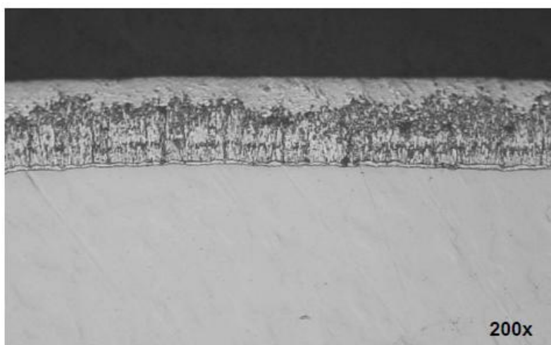
Struktura powłoki, 200x, traw. Nital
